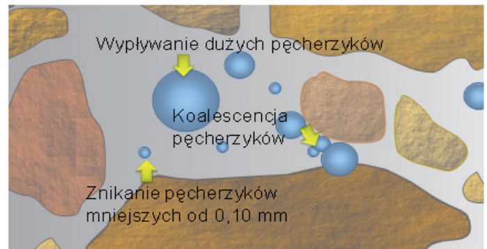
Rys. 5. Możliwe zmiany napowietżenia mieszanki samozagęszczalnej
